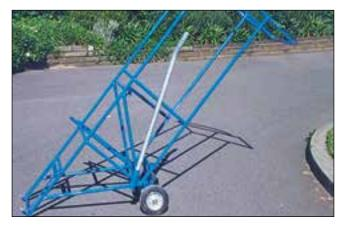
Fig. 4.3 – Hebel hoist
