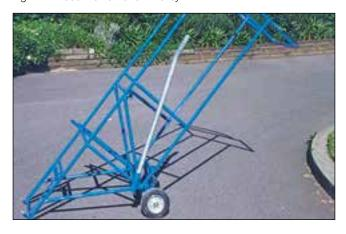
Fig. 4.3 – Hebel hoist
