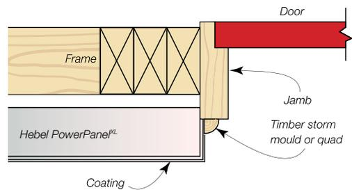
**Figure 3.5.8.7 Garage door – jamb detail – Option 2**
