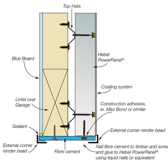
**Figure 3.5.8.6 Garage door – jamb detail – Option 1**
